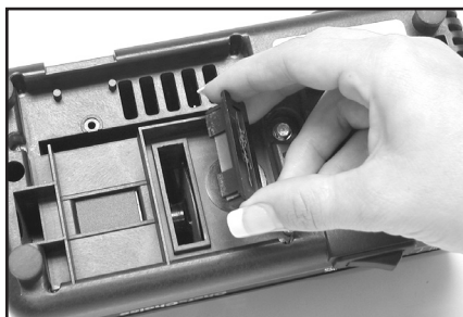
Bild 18. Ta bort luckan under botten för att rengöra från metalldamm (Se avsnittet om normalt underhåll)
